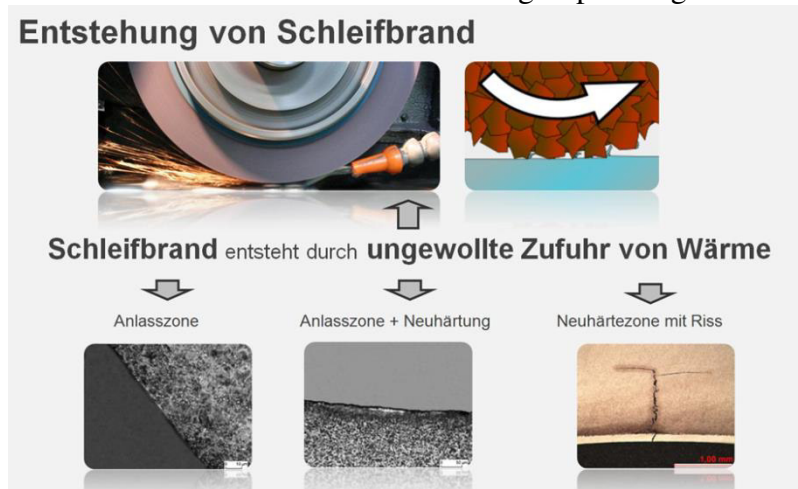
Bild 1 Entstehung und Erscheinungsformen von Schleifbrand
