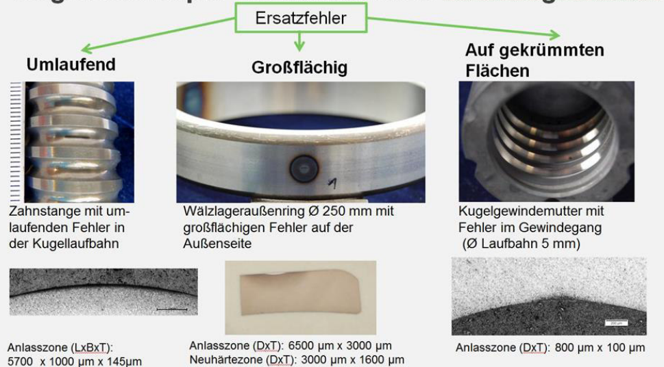
Bild 3 umlaufender Ersatzfehler auf einer Zahnstange, großflächiger Ersatzfehler auf einem Wälzlagering D=250 mm und Ersatzfehler auf der gekrümmten Oberfläche einer Gewindemutter (untere Bilder: Querschliffe durch die Ersatzfehler)
