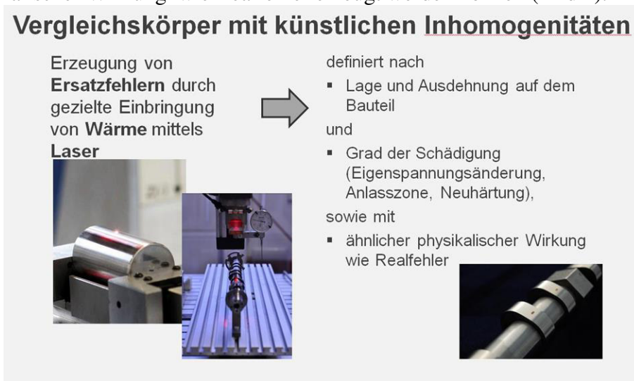
Bild 2 Erzeugung künstlicher Inhomogenitäten/Ersatzfehlern mittels LASER-Strahlung und kreisförmige Ersatzfehler d=1,2\text{ mm} auf einer Nockenwelle
