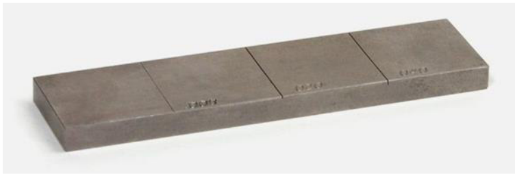
Bild 7 Vergleichskörper für die Wirbelstromprüfung mit eingebrachten Nuten Product ID: 3-Notch Eddy Current Standard, 4340 Steel Nuten Tiefe: 0,2; 0,5; 1,0, mm Breite 0,1 bis 0,12 mm PH Tool Pipersville, PA 18947 USA
