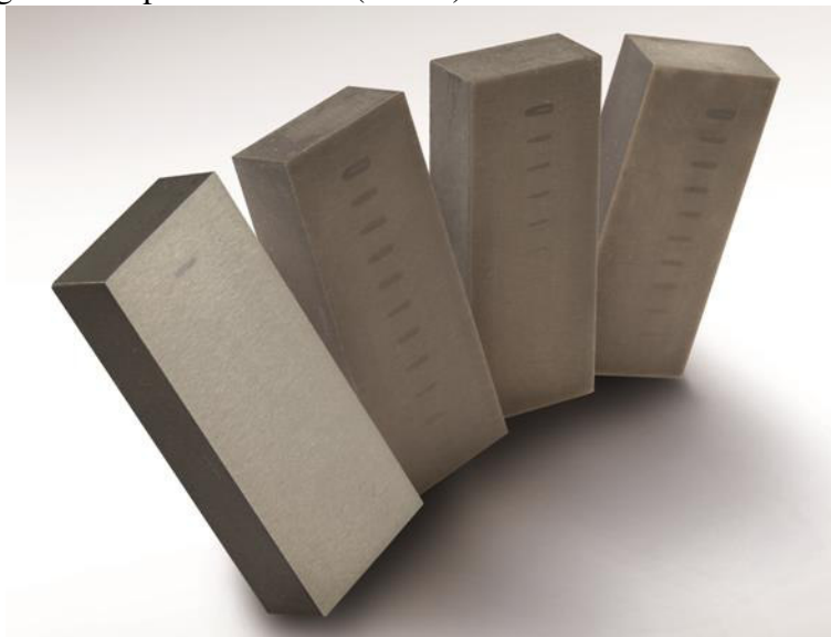
Bild 6 NE-Test Set–Vergleichskörper für die Überwachung des Nital-Ätzens www.imq-gmbh.com
