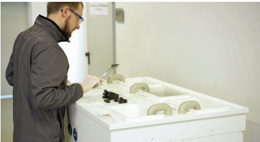
1 Mobile Ätzeinrichtung für das Nital-Ätzverfahren © imq
