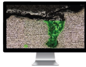
Darstellung der Verteilung von Sauerstoff in einer korrosiven Randschicht, lichtmikroskopische Aufnahme und Ergebnisse der EDX-Analyse
